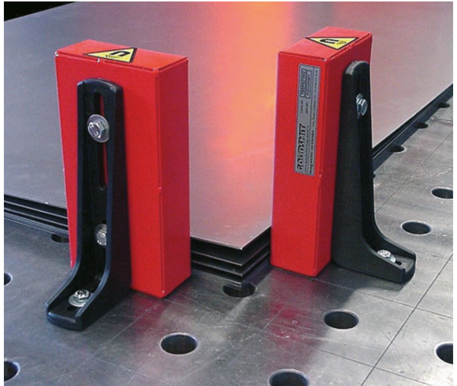
Permanente, niet schakelbare platenscheiders in permanent ferriet of neodymium uitvoering; neodymium is 30% krachtiger en geschikt voor platen met veel olie in een beperkte ruimte.
